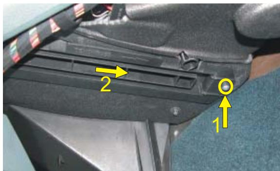
**PL** Odkręcić wkręty pokrywy filtra, usunać pokrywę
